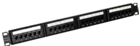
Патч-панель 24 порта RJ-45 категория 5e UTP (8 контактов) размер 1.75"x19"
